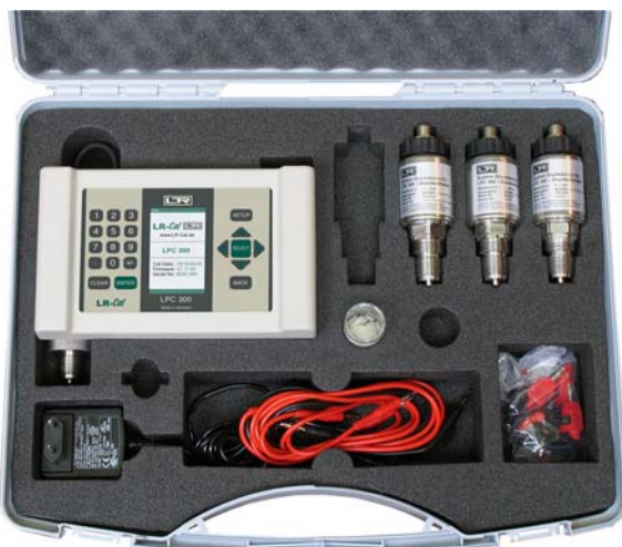
Abbildung links: LR-Cal LPC 300 mit 4 Referenzsensoren LR-Cal LPC-S im optionalen Aufbewahrungs- und Transportkoffer
